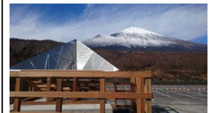
人工衛星校正検証用コーナーリフレクター （富士山御殿場口新五合目駐車場）
