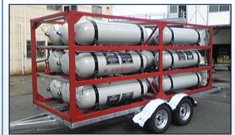
バイオガス運搬用トレーラー (クリーンエネルギー運搬に活用)
