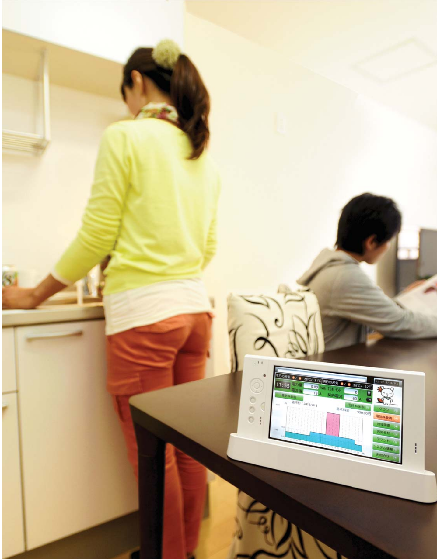
各家庭に設置された「宅内表示器」。 需要状況に応じた電気料金や省エネガイドンスを表示
