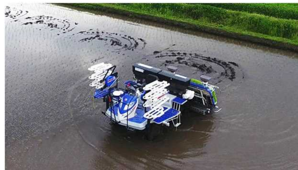
無人作業中の自動運転田植機 (ほ場端で自動旋回している様子)
