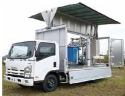
メタウォーター株式会社は、カンボジア・ケップ州に「車載式セラミック膜ろ過装置」を納入
